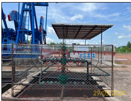
ภาพที่ 2.5-14 หลุมอัดกลับน้ำ (Injection Well)
