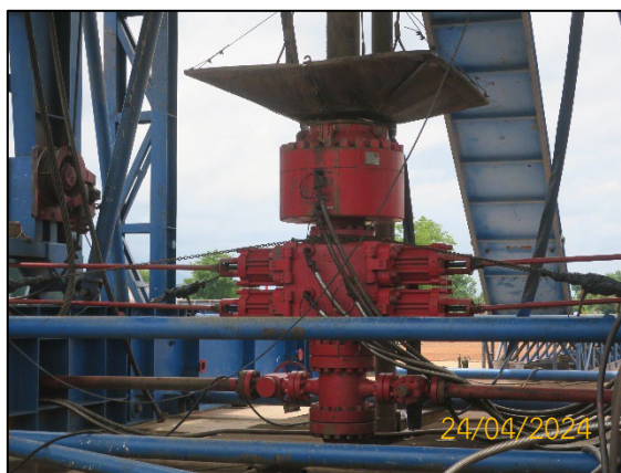
ภาพที่ 2.6-5 อุปกรณ์ป้องกันการพลุ่ง (Blow Out Preventer : BOP)
