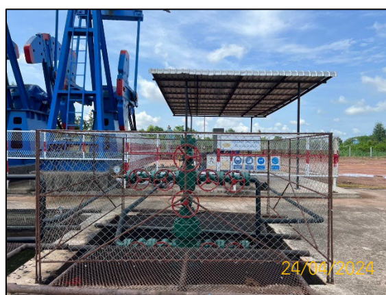
ภาพที่ 2.3-9 หลุมอัดกลับน้ำ (Injection Well)
