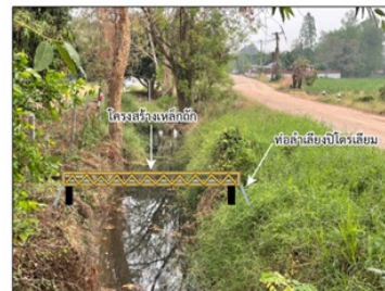
รูปแบบการก่อสร้างแนวท่อลำเลียงฯ บริเวณที่ตัดผ่านถนนและตัดผ่านคลองส่งน้ำ
