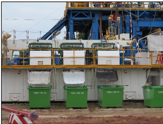
ระบบแยกเศษหินและโคลน (Shale Shaker)
